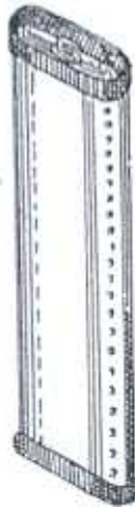
Núm. 57.—Calorifere para coches, construido en chapa de hierro estañado, de dos milímetros de gruesa, remachado, aros de hierro forjados, tapón de latón.
