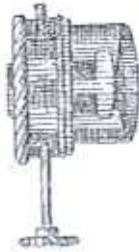
Núm. 38.—Portamechas de nueva línea para discos y linternas de señales.
