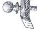
Num. 70. — Muelle de acero y latón interior de linterna de señal de cola de tren.
