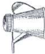
Núm. 59.—Aceitera de pico, para engrasar, de dos kilos y un kilo.
